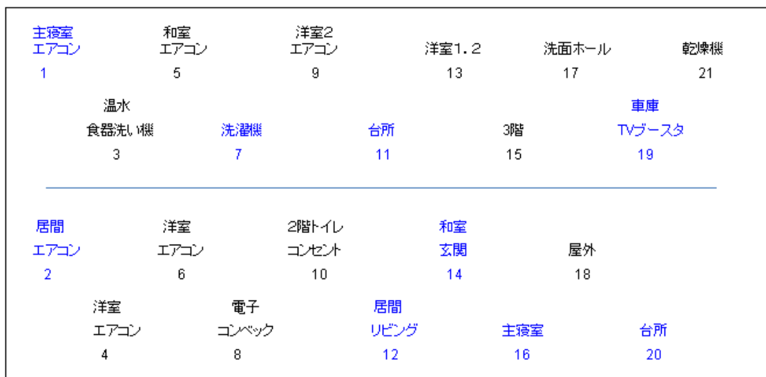
図 4-50 分電盤の系統分岐状況（上半分が L1 層、下半分が L2 相
